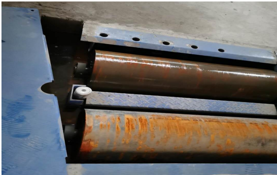
图 6 机械学院发动机测功仪器生锈情况
