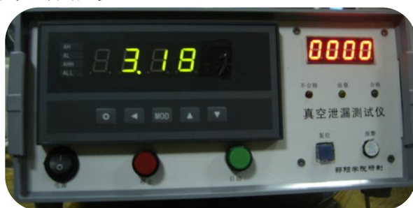
图20 与华盛科技联合开发的“真空泄漏测试仪”
